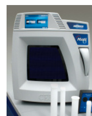
Schnelles Eindampfen und Abrauchen von HF im MicroVap
