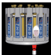
Schnelles Eindampfen und Abrauchen von HF im MicroVap
