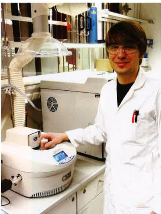
Abb. 1: Die Synthesemikrowelle CEM Discover SP mit Kamera.
