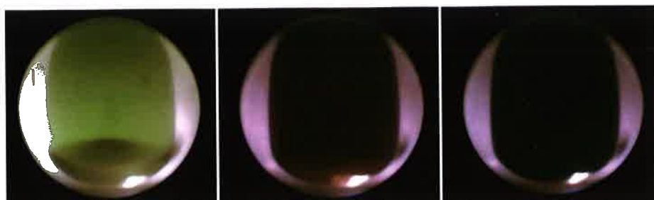
Abb. 3: Beobachtung der Reaktion von \text{Bi}_2\text{Ir} mit der Kamera. Links die grüne Lösung zu Beginn, in der beim Erhitzen der Reduktionsprozess startet und das schwarze intermetallische Pulver ausfällt (Mitte und rechts).
