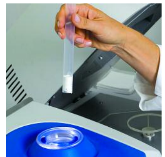
Schritt 3: Einstecken der Probe in die NMR-Kammer zur Fettbestimmung
