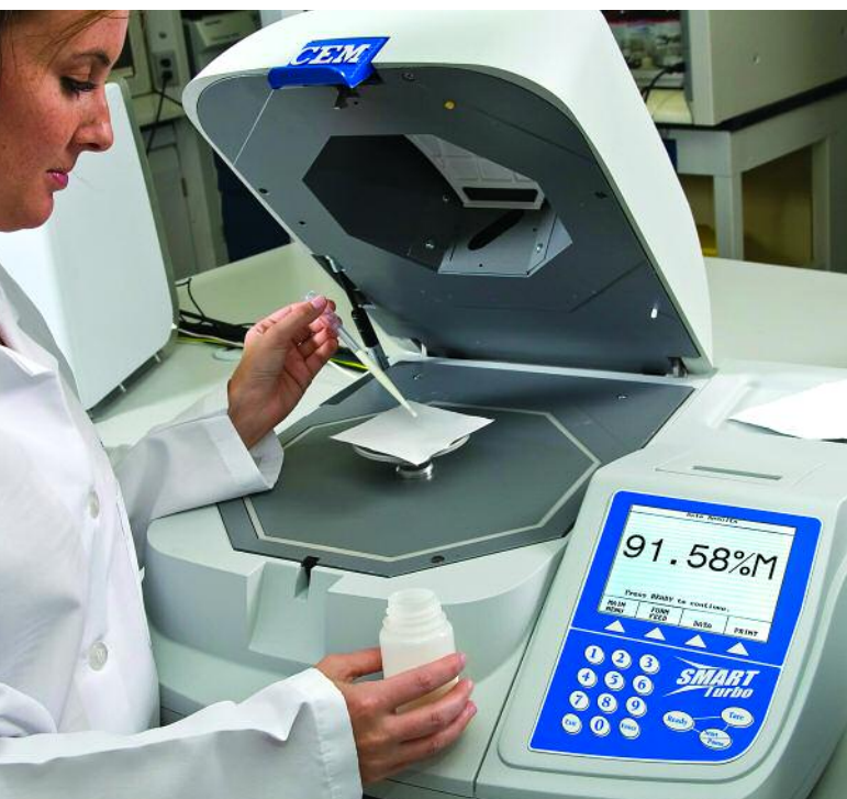
Schritt 1: Trocknen der Probe im Mikrowellentrockner
