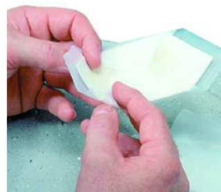
Schritt 2: Einrollen der getrockneten Probe im Trac Film
