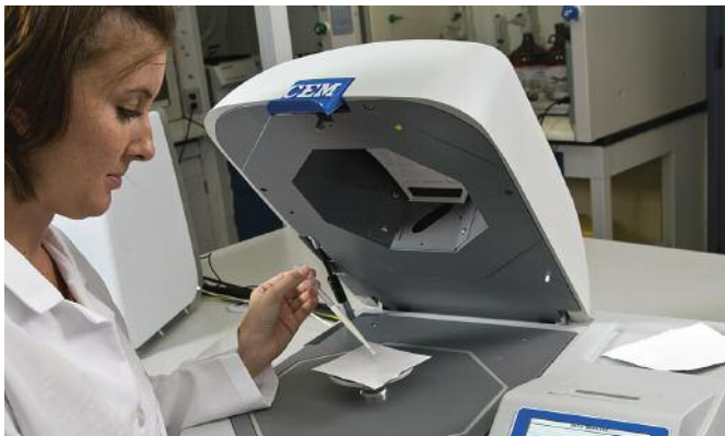
Smart Turbo: Mikrowellen-Trockner Feuchte- und Feststoffgehalte in nur 2 min.
