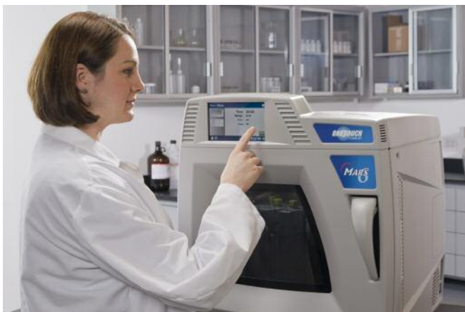
Chemische Reaktionen in der Mikrowelle mit Touch-Screen Bedienung.
